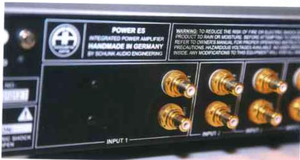
Accoustic Arts Power ES備有可以加配MC/MM唱頭輸入的配件選擇。這裡可見，Input 1的左側，已預留適當位置，供加裝相關輸入端。
