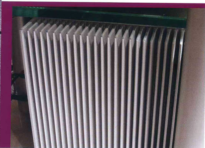
AMP III双单声道后级在机身的左右两侧都布置着整块散热片模组
