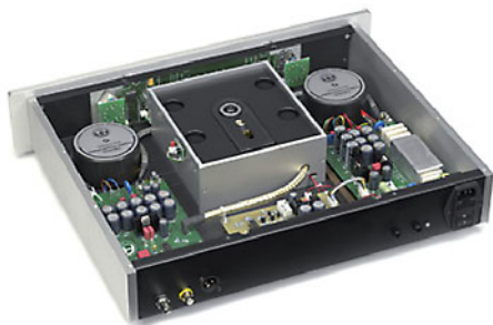
Noch fehlt die Beschriftung der Rückwand und die Lötstopmaske einer Platine, der hohe mechanische und elektronische Aufwand im Drive II wird aber deutlich
