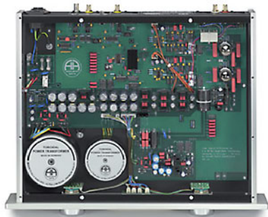
Oben in der Mitte unter dem schwarzen Kühlkörper sitzt der Mikrocomputer, der das Digitalsignal vor der Wandlung auf wohl einmalige Art aufbereitet
