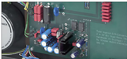
Die Spannungsversorgung der Röhren übernimmt ein eigenes Netzteil
