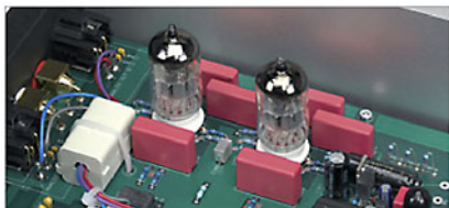
In der Hybrid-Ausgangs- und -Filterstufe arbeiten zwei 12AX7 von JJ
